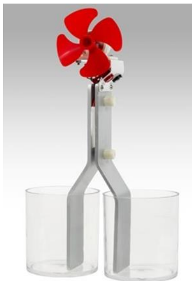
Ryc. 3. Przyrząd do obserwacji zjawiska Peltiera i Seebecka
